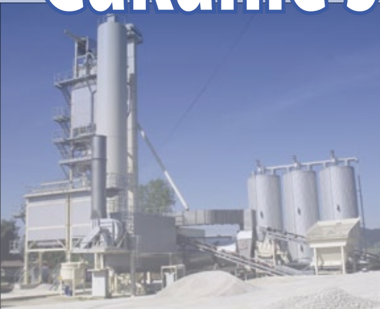
Obalovačacia súprava AMMANN počas skúšobnej prevádzky.
