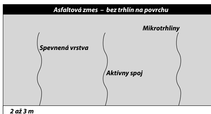
Pozdĺžny rez vozovkou s aktívnym spojom.
